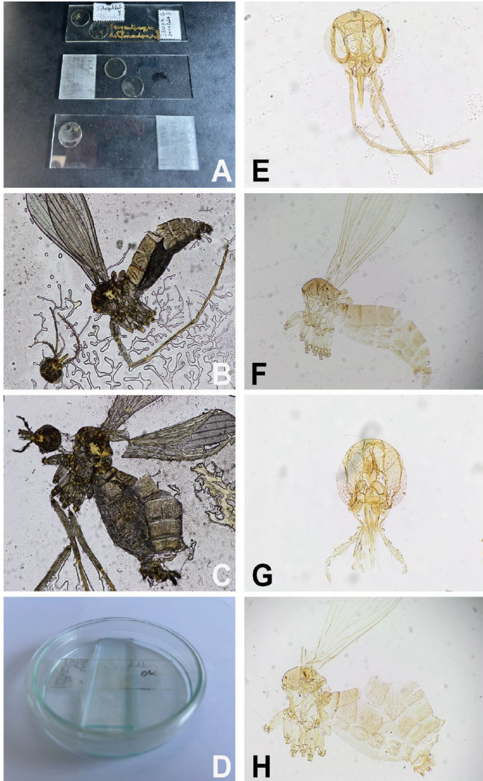
Рисунок 8: Перемонтировка препарата. А: поврежденные и высушенные предметные стекла в жидкости Хойера; В: микроскопическое изображение высушенного москита; С: микроскопическое изображение другого повреждённого москита; D: влажная камера, содержащая высушенное предметное стекло; E: голова и F: тело образца В после перемонтировки в среде Euparal®.
